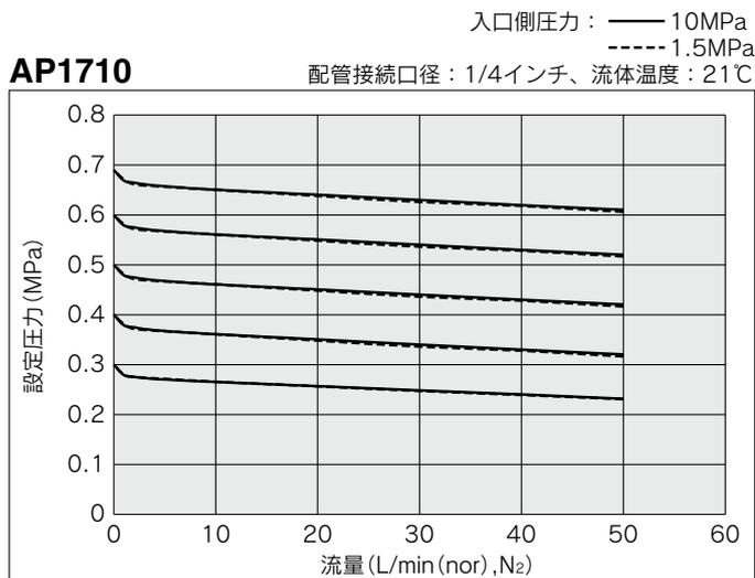
注) L/min (nor), N<sub>2</sub>は、N<sub>2</sub>ガスを流したときの、基準状態(0℃, 1atm)における体積流量を示します。
